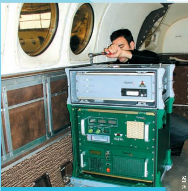
Installation du matériel Lidar dans l'avion avant le vol.
